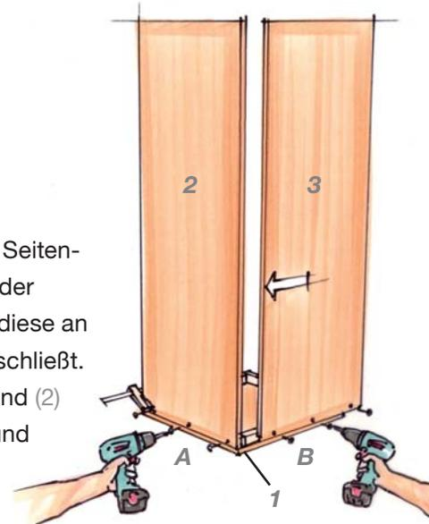
Bohren Sie auch hier die Schraublöcher vor und verwenden Sie die 4 x 40er-Schrauben (11). Streichen Sie etwas Holzleim auf die Längskante der Seitenwand (3) an der die beiden Seitenwände aufeinanderstoßen, stellen Sie diese dann auf die Kante B und verschrauben diese ebenfalls mit dem Vierkantholz (4). Achten Sie darauf, dass die beiden Seitenteile (2 und 3) dicht aneinander stoßen.
