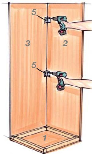
**5** Verbinden Sie direkt anschließend (solange der Leim noch nicht angetrocknet ist!) die beiden Seitenwände von der Innenseite mit den Winkelverbindern (5). Achten Sie darauf, dass die beiden Seitenwände (2 und 3) bündig miteinander abschließen. Verwenden Sie zur Befestigung der Winkel (5) 3,5 x 16er-Schrauben (12).
