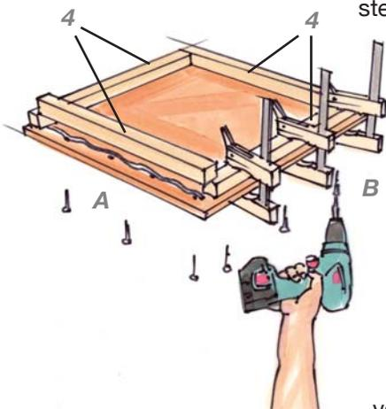
Bodenplatte (1) und Vierkantholz (4) Leim auf, fixieren Sie das Vierkantholz mit Klemmzwingen an der richtigen Position und verschrauben es
