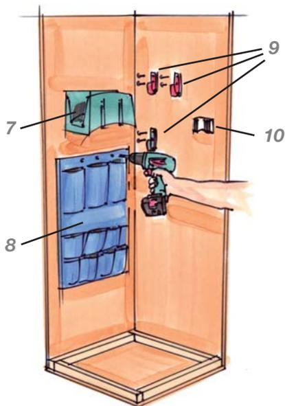
**8** Um die Innenausstattung zu montieren, stellen Sie zuerst Ihren Staubsauger in die „Besenkammer“, um die richtige Höhe für den Schlauchhalter (7) zu ermitteln. Befestigen Sie den Schlauchhalter (7) und den Hängeorganizer (8) mit Hilfe von Unterlegscheiben (13). Schrauben Sie anschließend die Unihaken (9) und den Gerätehalter (10) fest. Verwenden Sie hierzu 3,5 x 16er-Schrauben (12).
