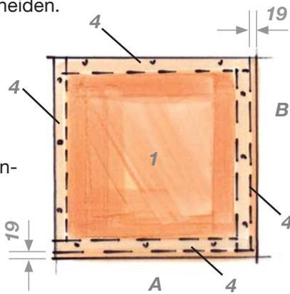
**3** Nun schrauben Sie ein Vierkantholz (4) nach dem anderen auf die Bodenplatte. Tragen Sie hierzu an den Verbindungsstellen zwischen
